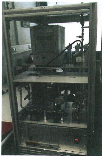
Abbildung 2: Aufbau eines WCCAP-Mobilitäts-Partikelgrößenspektrometers
